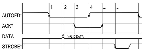
**Figure 43: Byte mode cycle**
