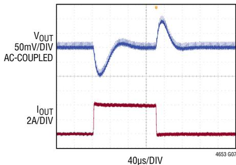
FIGURE 32 CIRCUIT,  $48V_{IN}$ ,
