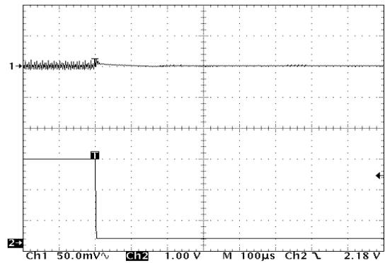
$V_{IN} = 1.5\text{ V}$ ,  $L = 22\text{ }\mu\text{H}$
